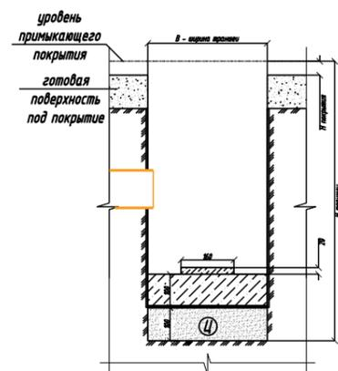
6 Установка пескоуловителя по уровню на раствор. Подключение отводящего патрубка
