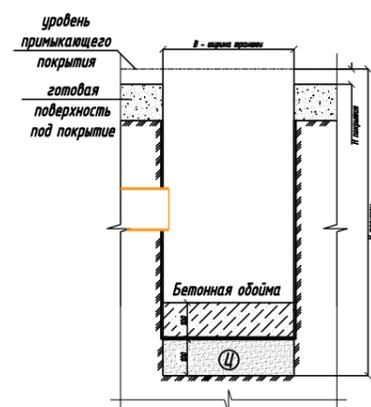
5 Выравнивание лотка бетонным раствором Н20 мм
