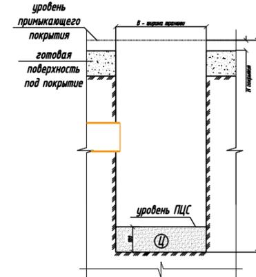
3 Пароизоляционная пленка под обойкой, выставить опалубку
