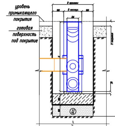
7 Заливка бетонной обойки сбоку от пескоуловителя. Установка решетки и крепежа обязательна
