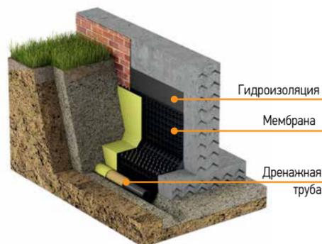
Дренажные трубы могут поставлять в защитном фильтре из геотекстиля. Геотекстиль предотвращает забивания отверстий и полости дренажной трубы песком и частицами грунта тем самым предотвращая их заиливание и закупоривание.
