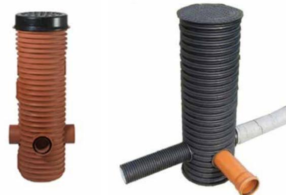
Смотровые/ревизионные колодцы предназначены для инспектирования и обслуживания системы трубопроводов. С одной стороны, смотровые колодцы позволяют отслеживать состояние и пропускную способность труб, контролируя уровень их засорения, а с другой – именно через них производится прочистка трубопроводов струёй воды под давлением. Если промывку системы предполагается производить вручную со спуском внутрь колодца, то он должен быть диаметром от 55 см. В остальных
