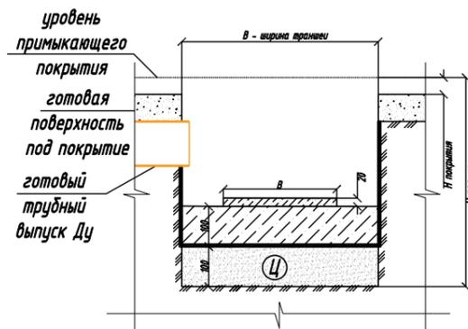
6 Установка дождеприемника по уровню на раствор. Подключение отводящего патрубка
