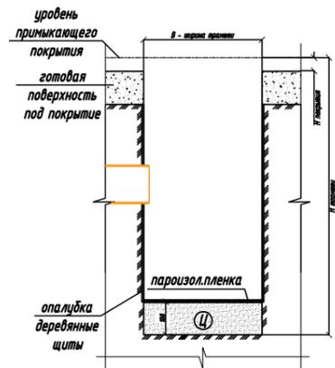
4 Нижний слой бетонной обойки - марка В30
