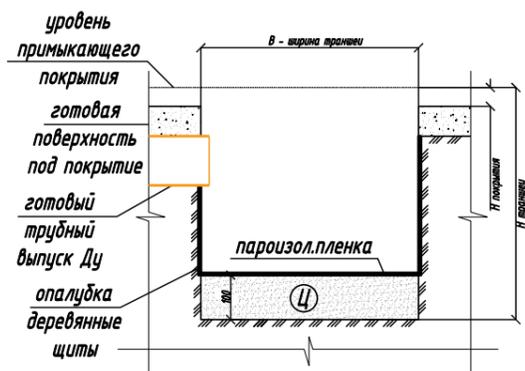
4 Нижний слой бетонной обоймы - марка В30
