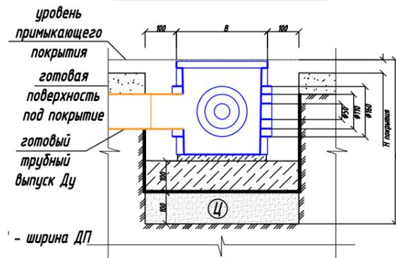
7 Заливка бетонной обоймы от дождеприемника. Установка решетки обязательна
