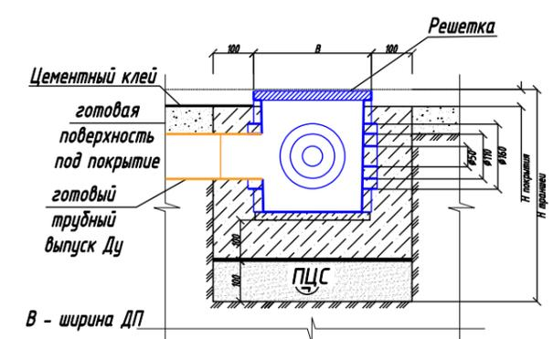
9 Установка плитки/асфальта выше уровня дождеприемника на 5 мм
