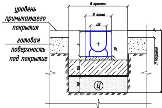
7 Заливка бетонной облойки от лотка
