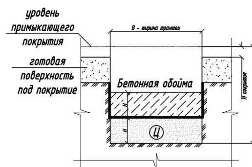
5 Выравнивание лотка бетонным раствором Н20 мм
