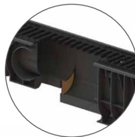
Возникают ситуации, когда невозможно создать желаемый уклон с помощью поверхности, но при этом поверхностный водоотвод необходим и должен надёжно функционировать. Для этого лотки могут быть разных высот, позволяющих при установке создавать так называемый «каскад», то есть перепад высот, с помощью которого вода через пескоуловитель будет течь в дождевую канализацию.
