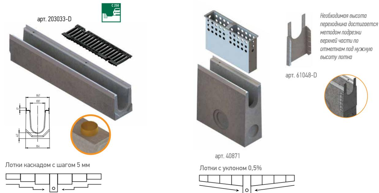
Необходимая высота переходника достигается методом подрезки верхней части по отметкам под нужную высоту лотка
