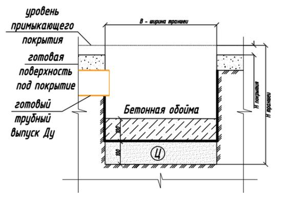
5 Выравнивание дождеприемника бетонным раствором Н20 мм
