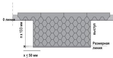
Если размер x составляет 50 мм или меньше, можно первый ряд плиток начинать от разметочной линии вверх поверх карнизной полосы.
