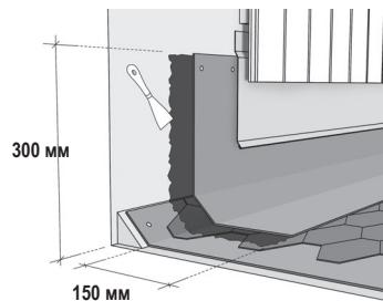
Вырезать полосы ковра, необходимые для устройства подъемов наверх, из ендового ковра Kerabit, или Kerabit 10+. Поднимающиеся полосы должны заходить на вертикальную поверхность не менее чем на 300 мм, и не менее чем на 150 мм на покрытие из гонтов. Приклейте полосы по всей поверхности и механически закрепите их за верхний край. В местах соединений уложите ковры с нахлестом 150 мм и прикрепите к основанию гвоздями край нижнего ковра с шагом приблизительно 100 мм.
