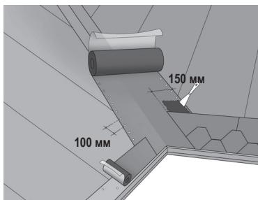
Самоклеящийся ендовый ковер под цвет кровли укладывается в ендову поверх подкладочного ковра и фиксируется гвоздями с шагом 100 мм.
