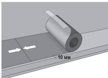
Далее на карнизную планку карнизного свеса приклеивается самоклеящаяся карнизная полоса Kerabit. Нижний край полосы укладывается примерно на 10 мм выше места сгиба планки. Снимите с полосы защитную пленку и прижмите ленту к планке. В местах соединения полосы монтируются плотно друг к другу.
