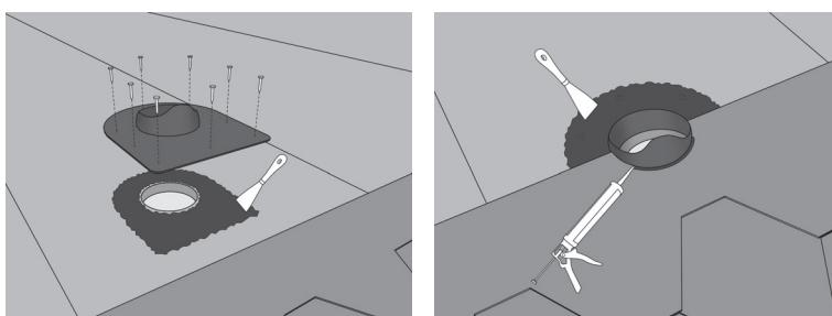
Сквозной проход устраивается при помощи подходящих уплотнений следующим образом: приклеить по всей площади фланец уплотнения сквозного прохода к подкладочному ковру не меньше, чем на расстоянии 150 мм. Закрепить края фланца саморезами или гвоздями. Вырезать в битумных гонтах по месту сквозного прохода отверстие соответствующей формы и размера. Приклеить гонты к фланцу и нижнему гонту битумным kleem минимум на 150 мм. В завершение обработайте сквозной проход битумным kleem.
