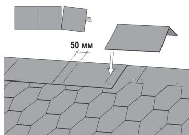
Конек монтируется из коньковых плиток Kerabit. Гвозди в верхнем ряду гонтов должны оставаться под коньковыми плитками. Сгибанием отделите плитки для конька (3 штуки) друг от друга. Защитную пленку снять, плитку для конька согнуть и прижать на место. Закрепить четырьмя гвоздями по краю так, чтобы гвозди остались под следующей плиткой для конька (нахлест плиток для конька должен составлять около 50 мм). Последнюю плитку закрепить только битумным клеем, не прибивать.
