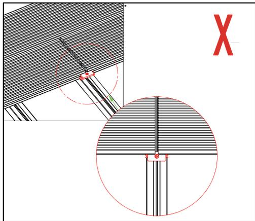
7. Необходимо использование сдвоенного ряда опорных лаг в местах стыков торцов основного профиля. При этом необходимо соблюсти продольный зазор вдоль лаг - 10 - 20 мм. Фиксация клипсой каждого торца декинга отдельно в данном случае является показателем правильности монтажа и может избавить Вас от неизбежной в противном случае замены досок, нарушивших свою геометрию вследствие несоблюдения необходимого термического зазора.
