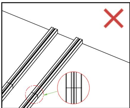
3. Оставьте зазор 10 - 15 мм на стыках между торцами двух опорных лаг.
