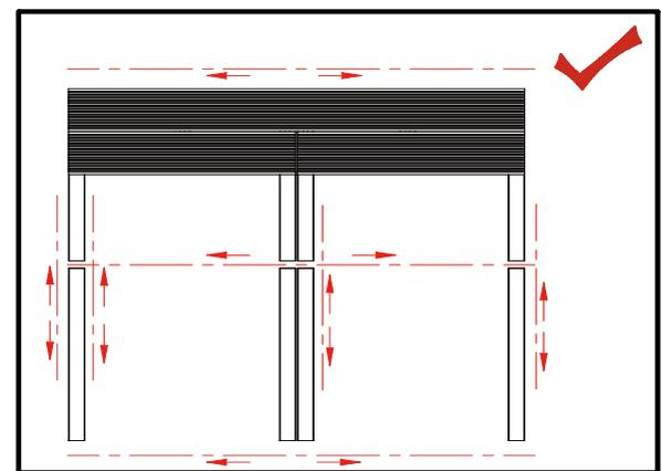
12. При хранении материала под навесом, декинг должен храниться плашмя, вдали от источников тепла и могущих нанести ему вред агрессивных веществ, острых предметов. При хранении материала под открытым воздухом, декинг должен храниться плашмя, без воздействия солнечного света, иначе геометрия досок может быть нарушена. При хранении декинга, тре-
