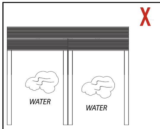
11. Декинг ДПК должен устанавливаться на поверхность с должным уровнем дренажа, в месте с хорошей циркуляцией воздуха и в при отсутствии скопившихся под покрытием грунтовых вод.
