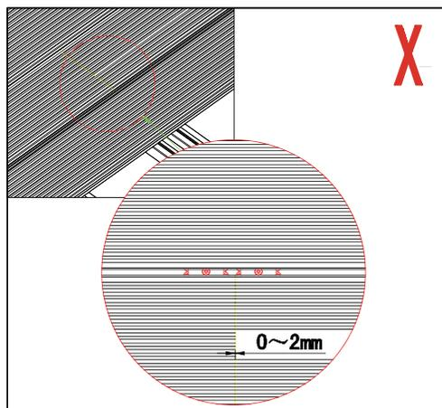
8. Устанавливая декинг ДПК, совершенно необходимо оставлять зазоры по торцам для термического расширения материала. Строго соблюдайте величину зазора между торцами. При необходимости используйте ровняющий чурбачок. Оставляйте между торцами как минимум 8мм (!) при длине доски 4 м и температуре воздуха при монтаже +10 С.
