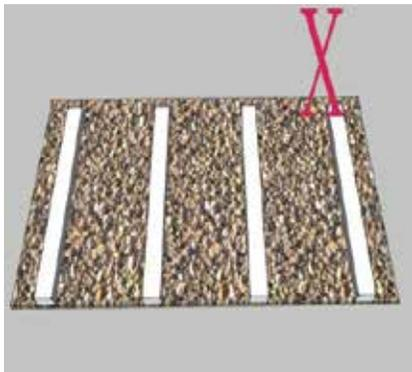
1. Декинг ДПК устанавливается на опорные лаги на прочное ровное основание. (для наилучшей фиксации лаги к бетону используйте дюбели или специальные лаги «CottageMode» наряду с фиксаторами лаг). Трава, неровные кирпичи или мощеная поверхность со временем могут заставить все покрытие сдвинуться.
