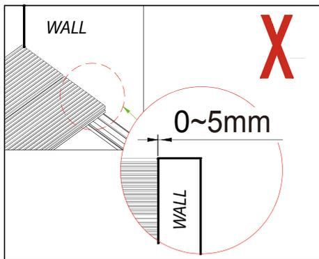
9. В случае близости террасы к стене, зазор между досками и стеной должен быть не менее 20 мм.
