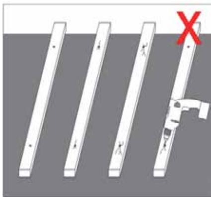
2. Рекомендуется производить предварительное просверливание опорных лаг перед фиксацией. В противном случае они могут треснуть. Расстояние между точками фиксации опорной лаги должно находиться в диапазоне 400 - 500 мм. Шурупы в точках фиксации лаги должны быть плотно подтянуты.
