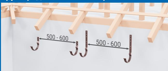
Держатели желоба устанавливаются на стропила или карнизную доску до монтажа кровельного покрытия.
