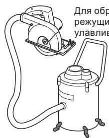
Для обрезки изделий используйте режущий инструмент, оснащенный улавливателем пыли
