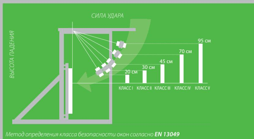
Стандарт EN 13049 предусматривает 5 классов безопасности, которые определяются путем испытаний – падением на окно тела весом 50 кг с определенной заданной высоты.
