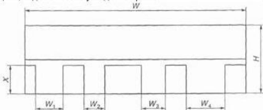
Рисунок 6 – Определение площади нахлеста для многослойной черепицы
